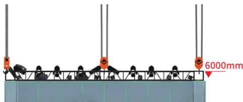
注: 图中需要反映出桁架的上沿口离地高度。
